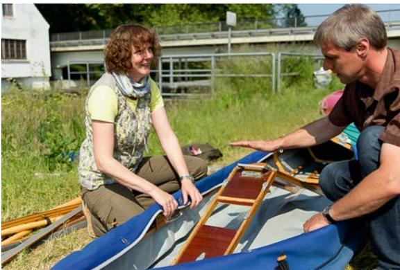
Die Bodenleisten werden durch Einhängen und Niederdrücken verbunden. In den 60er Jahren wurden sie noch aus dunklem Macoré-Tropenholz gefertigt.
