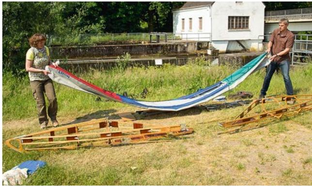
**Bild links:** Zusammengefaltet lässt sich das Boot leicht transportieren. **Bild rechts:** Erst in der Haut werden die zwei Gerüsthälften miteinander verbunden.
